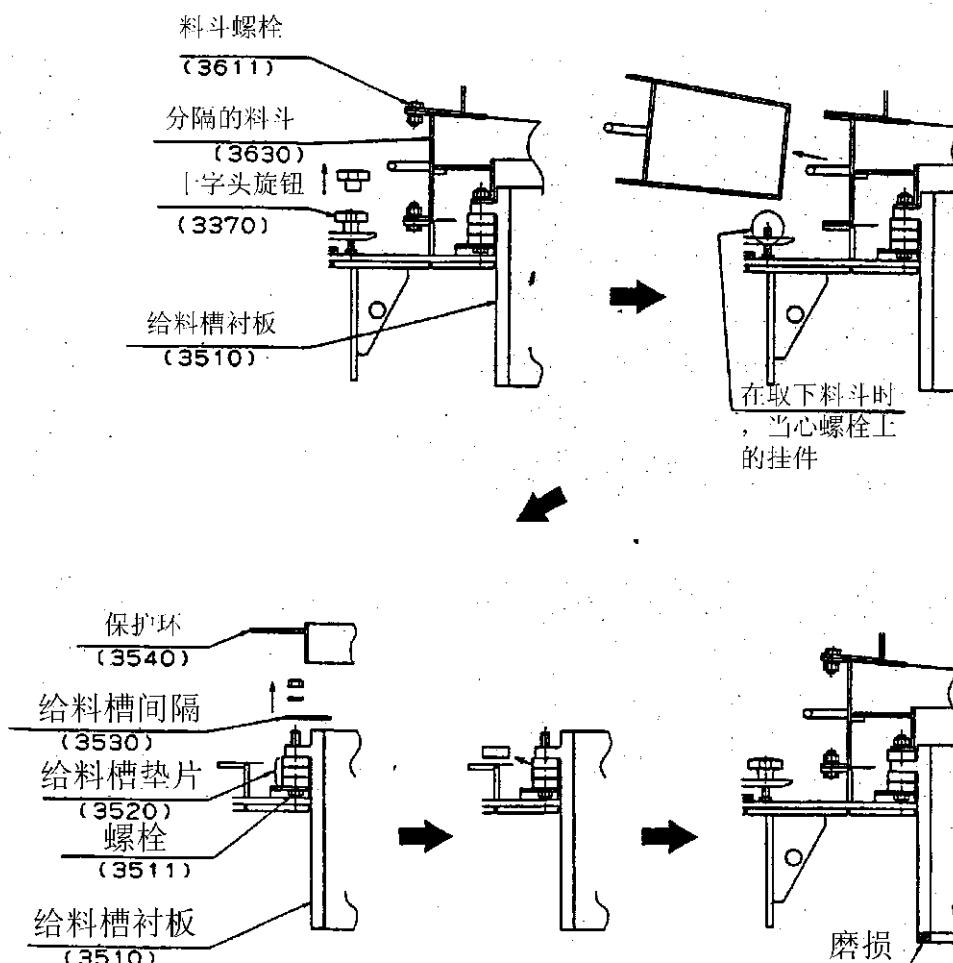
步骤一3：在进行调节时，将进料管垫片拉出，放在进料管衬的凸缘表面，安装给进料管垫然后拧紧进料管衬安装螺栓。放上保护套然后安装导管和料斗组件。
