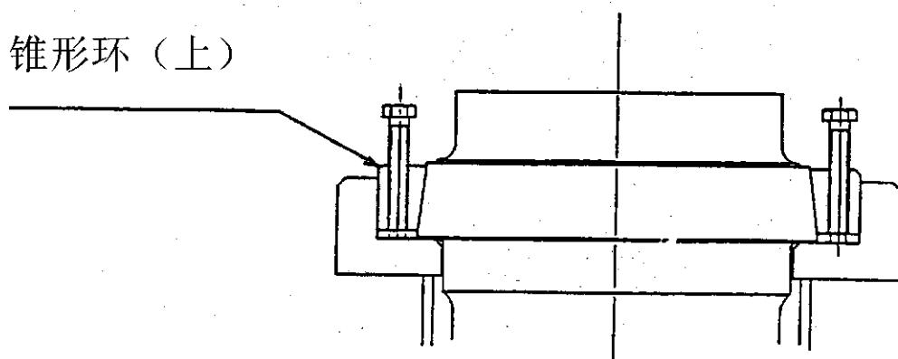
步骤一6：将工具箱中左旋螺纹有眼螺栓安装在主轴上攻丝孔内，连同轴承座组
