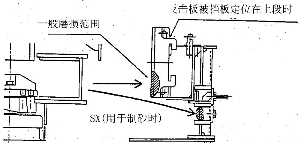
为改变反击板的固定位置，应该提前检查反击板的磨损范围，检查当其位置上升到上段时是否材料与该位置的接触低于反击板的下端。
