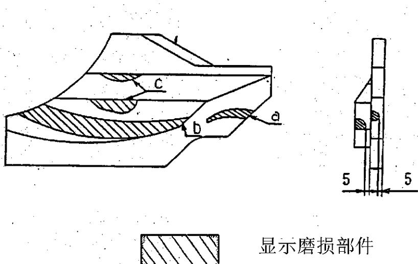
根据使用条件，部件—a，部件—b 或者部件—c 可能较早磨损，有必要根据最初使用结果确定磨损状态。
