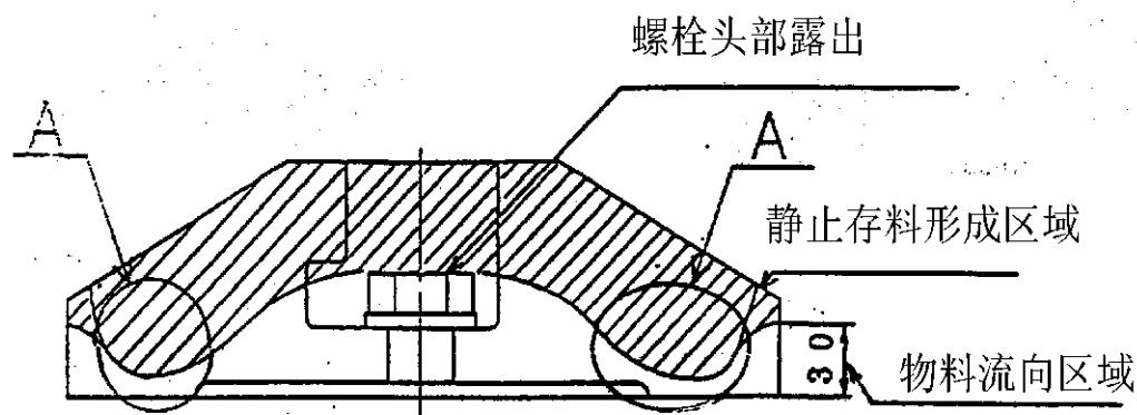
A部分是磨损最厉害的部分，然而不能通过检查门进行检查，应该观察物料的流向点和螺栓头部露出情况以确定分料盘是否需要更换成新的。（分料盘的上
