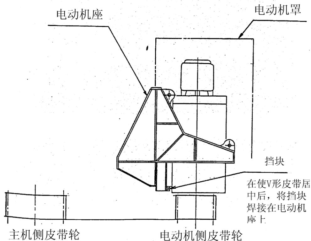
在 V 型皮带的端面完成平行居中
