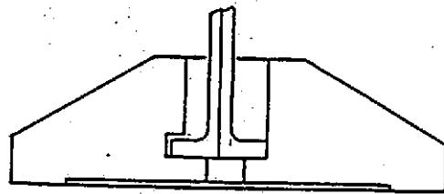
3) 如下图所示，采用螺栓固定分料盘与夹具表面对准。
