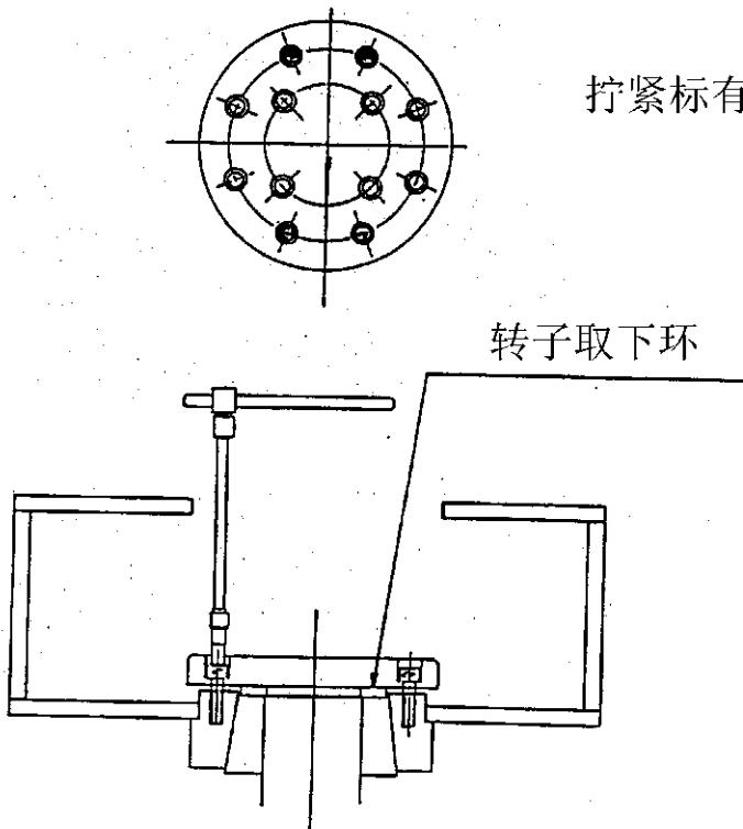
步骤一4：上紧螺栓后可以取下转子。提升转子并且将其从主机中取出。
